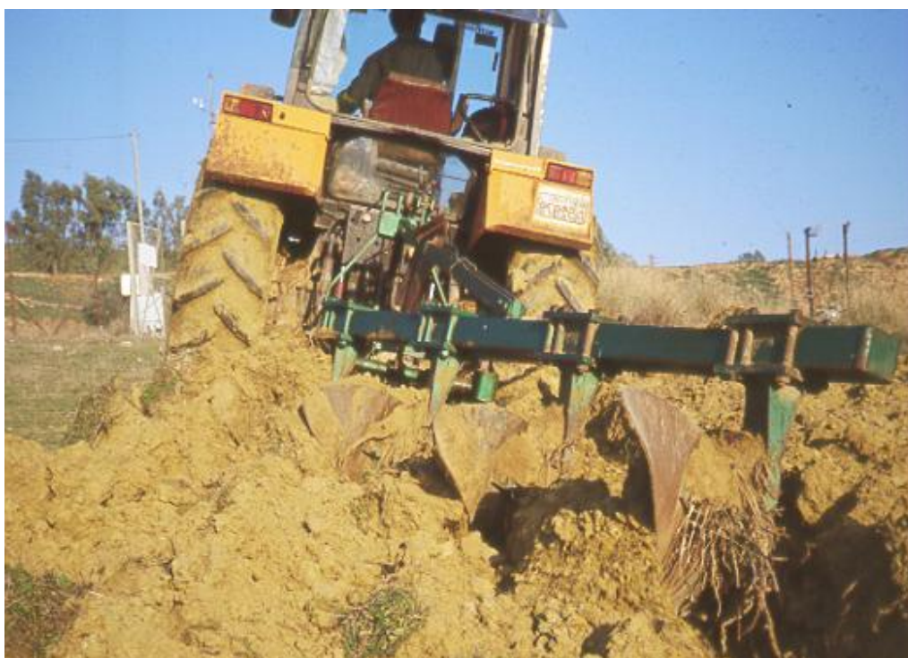
Εικόνα 79. Άροση σε βάθος 30 εκ προς στα ανάντη για την μέτρηση της μηχανικής διάβρωσης στο Αγρόκτημα Σπάτων
