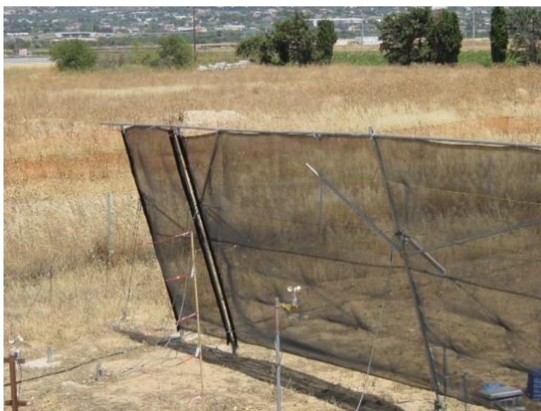
Εικόνα 191. Πείραμα μελέτης της αλληλεπίδρασης του ανέμου με καινοτόμο ανεμοφράκτη ελαστικής στήριξης.
