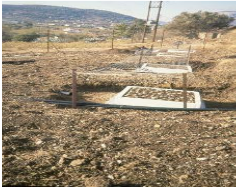
Εικόνα 194. Πείραμα μέτρησης της προσρόφησης των υδρατμών της ατμοσφαίρας από το έδαφος(θέση λόφος, δυτικά του αγροκτήματος).
