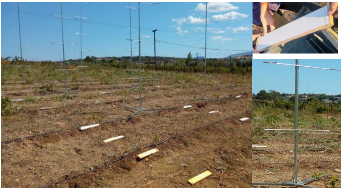
Εικόνα 183. Συλλέκτες (filter papers και polyethylene lines) για τη μέτρηση του καθιζάνοντος και του αερομεταφερόμενου ψεκαστικού νέφους (φώτο Γ. Μπουροδήμος).
