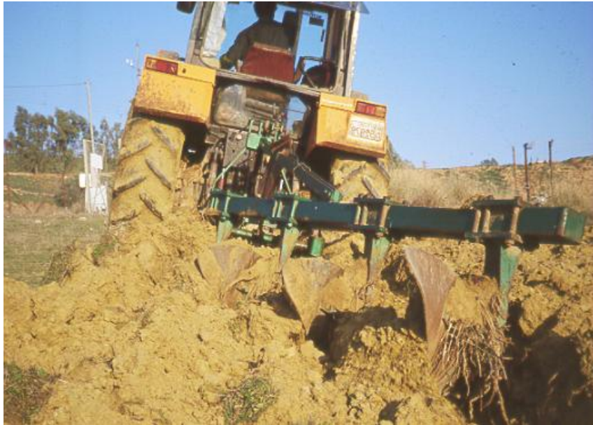
Εικόνα 195. Γεωργικός ελκυστήρας με άροτρο για την άροση εδάφους στον οποίο είχαν τοποθετηθεί δείκτες μέτρησης μηχανικής μετατόπισης (κύβους αλουμινίου) (θέση λόφος δυτικά του αγροκτήματος).
