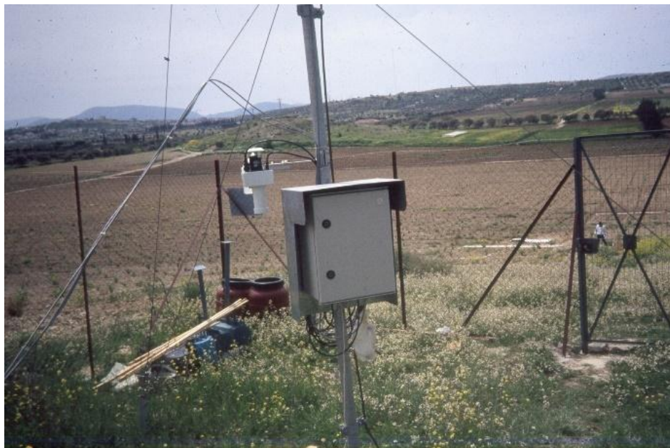
Εικόνα 193. Σταθμός συνεχούς ελέγχου και καταγραφής δεδομένων υδατικής διάβρωσης, εδαφικής υγρασίας, προσρόφησης υδρατμών ατμοσφαίρας, μετεωρολογικών δεδομένων κλπ. (θέση λόφος με ελαιώνα, δυτικά του αγροκτήματος).
