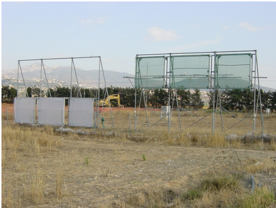
Εικόνα 190. Πείραμα μελέτης της ροής και των ανεμοπιέσεων πάνω σε υπερυψωμένους και μη ανεμοφράκτες με κάλυψη γεωργικού διχτυού ή πλαστικού φύλλου.
