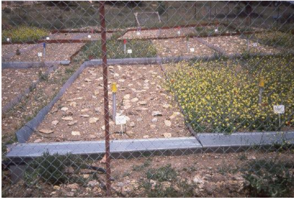
Εικόνα 192. Πείραμα εκτίμησης της επίδρασης των λίθων στη προστασία του εδάφους από την διάβρωση και την διατήρηση του εδαφικού νερού (θέση λόφος με ελαιώνα, δυτικά του αγροκτήματος).
