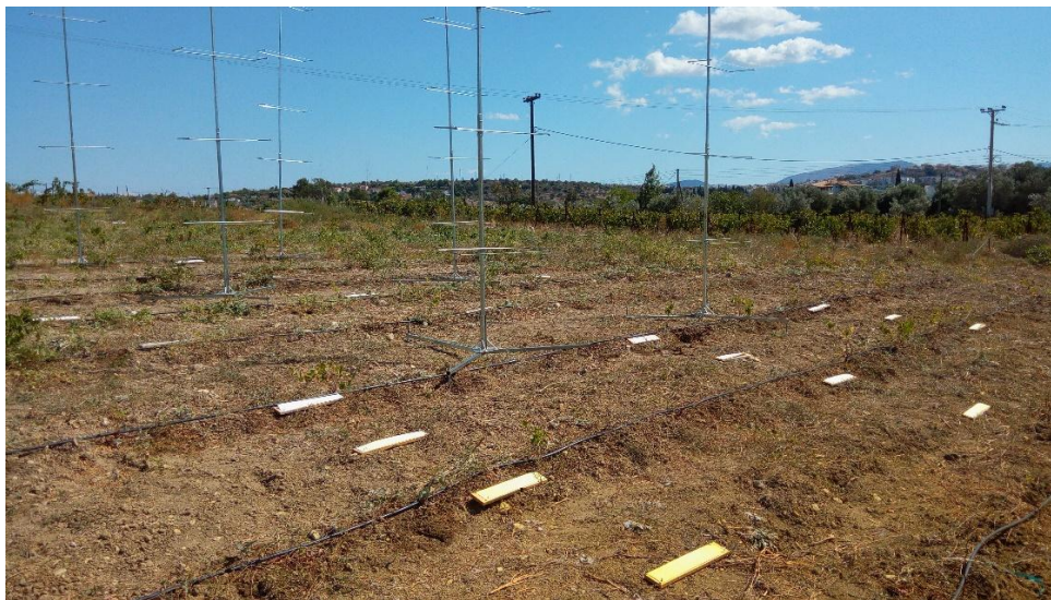
Εικόνα 115. Πειραματική διάταξη του Εργαστηρίου Γεωργικής Μηχανολογίας του Γ.Π.Α. για την μελέτη της διασποράς των σταγονιδίων ψεκαστικών διαλειμμάτων (φωτο Γεώργιος Μπουροδήμος)
