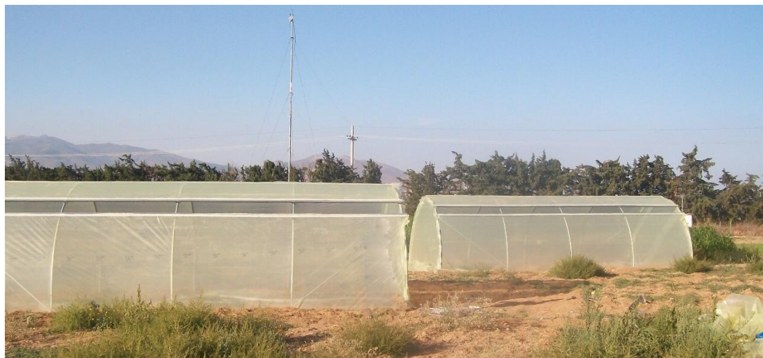
Εικόνα 185. Πείραμα φυσικής γήρανσης και επίδρασης αγροχημικών σε πολυστρωματικά πλαστικά φύλλα κάλυψης θερμοκηπίων.
